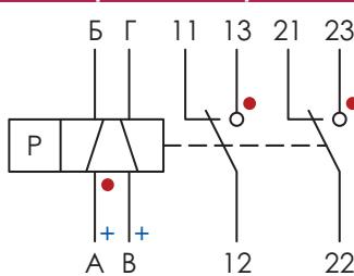
«●» – заданное начальное состояние реле при подаче напряжения на обмотку А – Б
