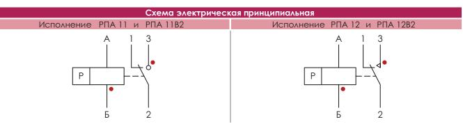
«•» – заданное начальное состояние контактов реле при подаче «+» напряжения на конец обмотки ритные, установочные и присоединительные размеры. Расположение выводов контактов и обмоток
