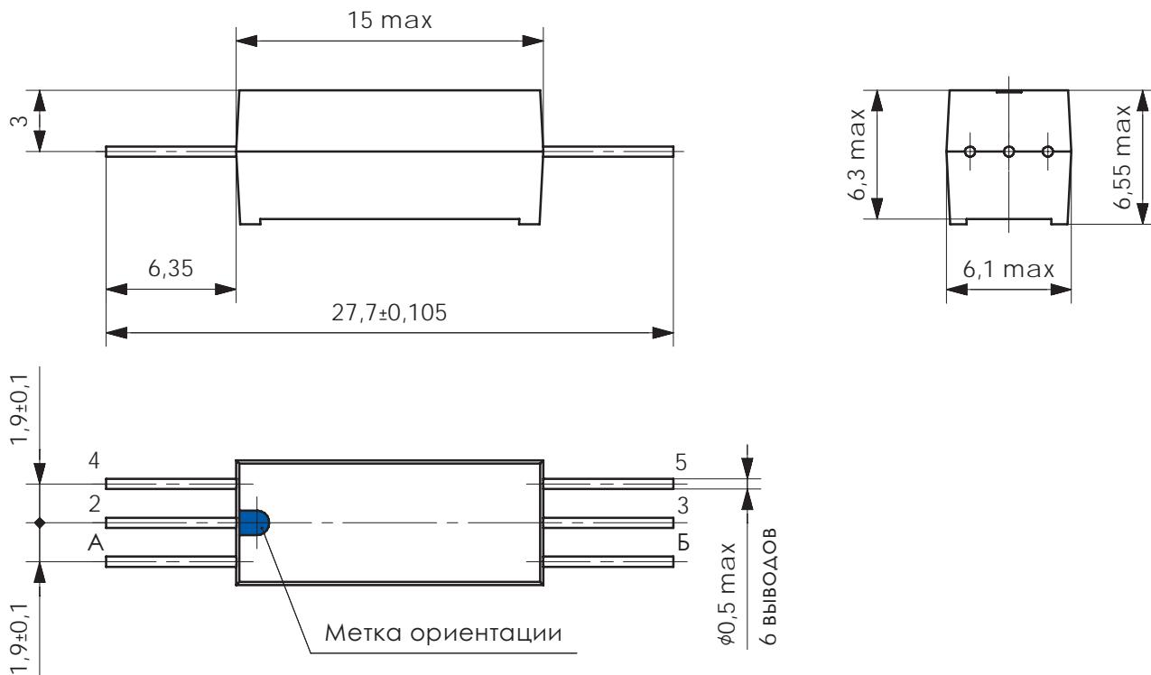
Поверхностный монтаж, без элементов крепления
