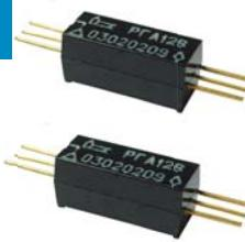
Предназначено для коммутации электрических цепей постоянного тока частотой коммутации до 100 Гц мощностью до 5 Вт и цепей переменного тока частотой от 400 до 1 000 МГц мощностью до 2,5 Вт с частотой коммутации до 100 Гц при согласованной нагрузке 50 Ом.
