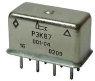
Предназначено для коммутации электрических цепей постоянного тока и переменного тока, частотой до 2 500 Гц.
