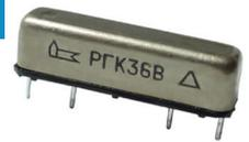
Предназначено для коммутации электрических цепей постоянного тока и переменного тока, частотой до 10 000 Гц.
