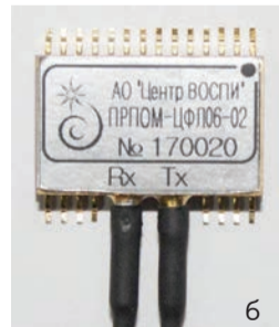
Фото 9 а) внешний вид металлокерамического корпуса, б) внешний вид собранного модуля
