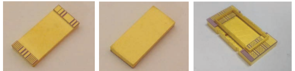
Фото 6 Внешний вид металлокерамических корпуса и оснований
