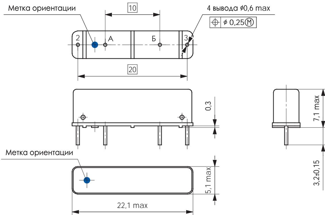
Технология пайки в отверстия (штыревые выводы, 4 шт.)
